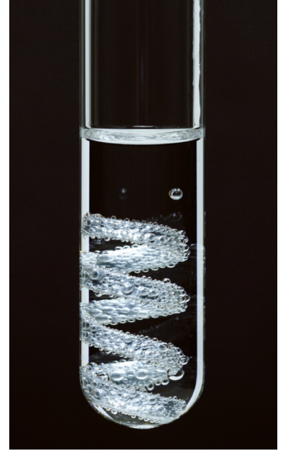
الشكل (9): تفاعل Mg مع حمض HCl المخفف.
