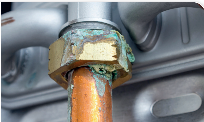
الشكل (19): تآكل فلز النحاس.
